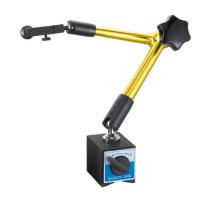
Das Bernardo Universal-Magnetmessstativ mit hydraulischer Klemmung ist ein vielseitiges Werkzeug für verschiedene Anwendungen. Es bietet eine Haftkraft von 50 kg und verfügt über einen Magnetfuß mit den Abmessungen 63 x 50 x 55 mm. Die Schaftaufnahme hat einen Durchmesser von 8 mm.
