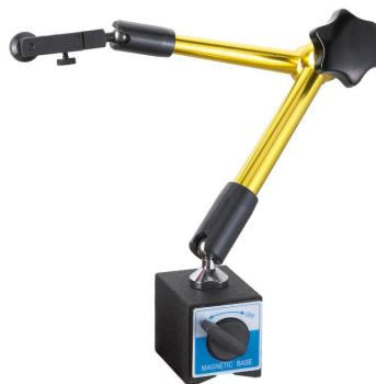
Das Bernardo Universal-Magnetmessstativ mit hydraulischer Klemmung ist ein vielseitiges Werkzeug für verschiedene Anwendungen. Es bietet eine Haftkraft von 50 kg und verfügt über einen Magnetfuß mit den Abmessungen 63 x 50 x 55 mm. Die Schaftaufnahme hat einen Durchmesser von 8 mm.
