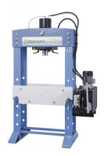
Die Bernardo HWP 60 Hydraulische Werkstattpresse mit verschiebbarem Zylinder ist ein leistungsstarkes Werkzeug für verschiedene Anwendungen. Die Presse verfügt über eine Druckkraft von 60 Tonnen und einen Durchgang zwischen den Ständern von 750 mm. Der Kolbenhub beträgt 380 mm und der Kolbendurchmesser 75 mm. Die maximale Druckkraft beträgt 259 bar.
