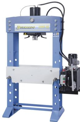
Die Bernardo HWP 60 Hydraulische Werkstattpresse mit verschiebbarem Zylinder ist optimal bei Montage- und Richtarbeiten, aber auch bestens geeignet zum Einrichten von Werkzeugen, bei Belastungstests und für Werkstückprüfungen. Der Tischhöhenverstellung erfolgt mittels Kette und Arbeitszylinder. Der Kolbenvorschub ist wahlweise mittels Handhebel oder feinfühliger Hydraulikpumpe möglich. Die schnelle Vorlauf- und Rücklaufgeschwindigkeit ermöglicht rationelles Arbeiten.
