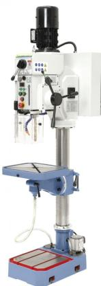
Das Modell GB 30 Vario ist eine schwere Getriebebohrmaschine mit stufenloser Drehzahlregelung, automatischem Pinolenvorschub und digitaler Drehzahlanzeige. Ihren Einsatzbereich findet dieses Modell hauptsächlich in Reparaturbetrieben und im Maschinenbau.
