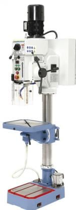
Das Modell GB 30 Vario ist eine schwere Getriebebohrmaschine mit stufenloser Drehzahlregelung, automatischem Pinolenvorschub und digitaler Drehzahlanzeige. Ihren Einsatzbereich findet dieses Modell hauptsächlich in Reparaturbetrieben und im Maschinenbau.
