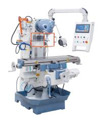
Die Universalfräsmaschine UWF 110 eignet sich zur Ausführung von leichten und mittelschweren Fräsarbeiten. Dank ihrer großen Vielseitigkeit und der einfachen Umrüstung kann sie in Werkstätten zur Bearbeitung von kleinen und mittelgroßen Serien mit Erfolg eingesetzt werden.
