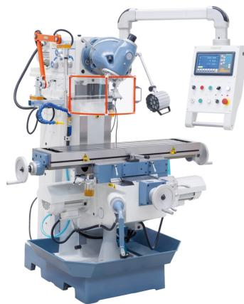
Die Universalfräsmaschine UWF 110 eignet sich zur Ausführung von leichten und mittelschweren Fräsanbeiten. Dank ihrer großen Vielseitigkeit und der einfachen Umrüstung kann sie in Werkstätten zur Bearbeitung von kleinen und mittelgroßen Serien mit Erfolg eingesetzt werden.
