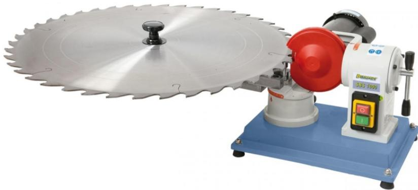
Die robuste Sägeblatt-Schärfmaschine SBS 1000 dient zum Schärfen von hartmetallbestückten und CV-Sägeblättern mit einem Durchmesser von 80 - 1000 mm. Durch die schwenkbare Motor-Schleifscheibeneinheit bzw. Sägeblatthalterung können die verschiedensten Verzahnungen geschliffen werden.
