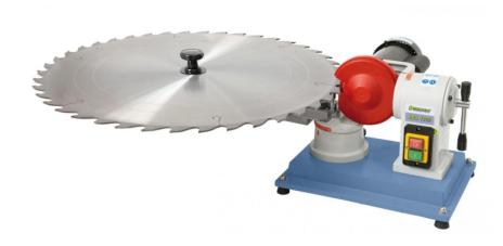
Die robuste Sägeblatt-Schärfmaschine SBS 1000 dient zum Schärfen von hartmetallbestückten und CV-Sägeblättern mit einem Durchmesser von 80 - 1000 mm. Durch die schwenkbare Motor-Schleifscheibeneinheit bzw. Sägeblatthalterung können die verschiedensten Verzahnungen geschliffen werden.
