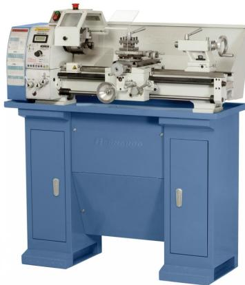
Die Drehmaschine Profi 550 LZ ist serienmäßig mit einer Leit- und Zugspindel zum Gewindeschneiden bzw. für den automatischen Vorschub ausgestattet. Neu bei diesem Modell ist die serienmäßige Rutschkupplung und der Mikrometerlängsanschlag. Weiters gibt es die Möglichkeit die Maschine nachträglich mit einem Fräsaufsatz FA 16 auszustatten.
