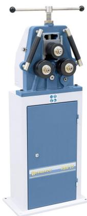
Die Bernardo RBM 25 Manuelle Ringbiegemaschinen sind ideal zum Biegen von Rohren und Profilmaterialien aus Stahl, Aluminium, Messing usw. Die Maschinen sind manuell angetrieben und verfügen über ein Untersetzungsgetriebe, das den Biegevorgang unterstützt. Die Einstellung der Oberwalze erfolgt über eine leicht einsehbare mm-Skala.
