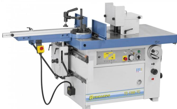
Die schwere Schwenkspindel-Fräsmaschine TS 1300 TC ist durch den serienmäßigen Zapfenschneidtisch für vielfältige Anwendungsmöglichkeiten geeignet. Ob Profilieren, Formfräsen, Zinkenfräsen oder Kopierfräsen, mit diesem Modell erzielen Sie immer beste Arbeitsergebnisse.
