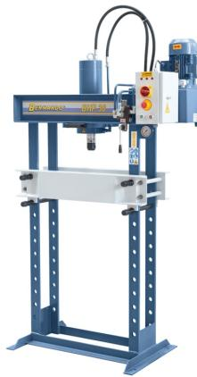
Die Bernardo BHP 30 Hydraulische Werkstattpresse mit verschiebbarem Zylinder ist ideal geeignet zum Ausrichten von Achsen, Wellen usw., aber auch zum Ein- und Auspressen von Bolzen, Lagern, Buchsen uvm. Sie ist serienmäßig mit einem seitlich verschiebbaren Zylinder ausgestattet und verfügt über eine Verstellvorrichtung für die Höhenverstellung des Arbeitstisches.
