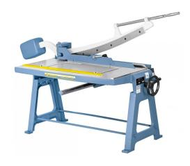
Die Bernardo HLS 1050 x 2,0 Handtafelscheren ist eine professionelle Schere für die Bearbeitung von Blechen. Die Schere hat eine Schnittlänge von 1050 mm und kann Bleche mit einer maximalen Stärke von 2,0 mm bearbeiten.
