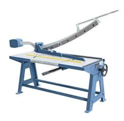
Die Bernardo HLS 1280 x 1,5 Handtafelscheren ist ein präzises Werkzeug für die Metallbearbeitung. Die Maschine bietet eine Schnittlänge von 1280 mm und eine maximale Blechstärke von 1,5 mm bei 400 N/mm². Der Hinteranschlag ist verstellbar von 0 bis 600 mm und der Tischanschlag von 240 bis 360 mm. Die Tischgröße beträgt 1565 x 600 mm und die Arbeitshöhe 770 mm. Die Maschinenabmessungen betragen 2400 x 1040 x 1600 mm und das Gewicht ca. 370 kg.
