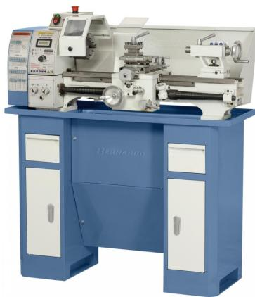
Die präzise Leitspindeldrehmaschine Profi 550 WQV wird nach den strengen Vorgaben des DIN-Standards gefertigt. Die Besonderheit dieses Modells ist der große Längsvorschubbereich mit 6 frei wählbaren Vorschüben sowie der serienmäßige Planvorschub. Zusätzlich verfügt dieses Modell über eine elektronisch verstellbare Drehzahlregelung.
