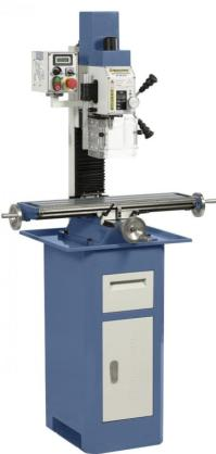
Die Bohr- und Fräsmaschine KF 25 L Vario ist bereits in der Grundausstattung mit einer digitalen Drehzahl- und Pinolenhubanzeige ausgestattet. Dieses Modell bietet zusätzlich einen Verfahrweg in der x-Achse von 490 mm. Ihren Einsatzbereich findet diese Maschine beim professionellen Anwender, im Modellbau und im Ausbildungsbereich.
