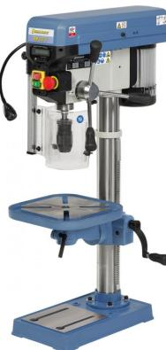
Die solide Bohrmaschine mit Keilriemenantrieb BM 20 T zeichnet sich durch das hohe Drehmoment selbst bei niedrigen Drehzahlen aus. Ihre Einsatzbereich findet dieses Modell beim Heimwerker und in Ausbildungswerkstätten.
