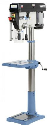
Die solide und technisch ausgereifte Säulenbohrmaschine SB 32 S ist mit einer Bohrleistung von 32 mm erhältlich, beim Einsatz von Kernlochbohrern können problemlos größere Bohrdurchmesser erzielt werden. Dieses Modell ist serienmäßig mit einem Rechts-Linkslaufschalter ausgestattet. Aufgrund ihres optimalen Preis-Leistungsverhältnisses wird dieses Modell vorwiegend von Modellbauern und Hobbyheimwerkern, aber auch in der Landwirtschaft sowie in Reparaturwerkstätten eingesetzt.
