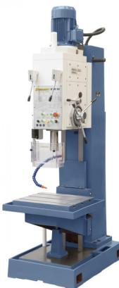
Die Kastenständerbohrmaschine KBM 50 ist für Bohr, Reib- und Gewindeschneidarbeiten sowohl in der Einzel- als auch in der Serienfertigung geeignet. Durch die massive Graugusskonstruktion kann dieses Modell für schwere Zerspannungsarbeiten in Maschinenbau, Produktion und Anlagenbau eingesetzt werden.
