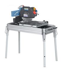
Die Bernardo SCM 350 - 400 V Steintrennmaschinen sind leistungsstarke Werkzeuge für die Steinbearbeitung. Mit einer Schnittliefe von 115 mm und einer Schnittlänge von 620 mm sind sie ideal für den Einsatz in der Steinindustrie. Die Maschinen verfügen über eine Diamantrennscheibe mit einer Größe von 350 x 25,4 mm und eine Tischgröße von 500 x 490 mm.
