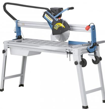
Die Bernardo SCM 300 - 230 V Steintrennmaschinen ist eine leistungsstarke Maschine für den professionellen Einsatz. Mit einer Schnitttiefe von 110 mm und einer Schnittlänge von 1200 mm ist sie ideal für das Trennen von Steinen und anderen Materialien. Die Maschine verfügt über eine Diamanttrennscheibe mit einer Größe von 300 x 25,4 mm und eine Tischgröße von 1305 x 490 mm.
