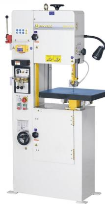
Die Vertikalbandsäge VMS 360 eignet sich zum Sägen von nahezu allen sägbaren Materialien (zB. Stahl, Kunststoff, NE-Metalle, Buntmetalle, ...). Ihren Einsatzbereich findet dieses Modell vorwiegend in der allgemeinen Produktion, im Werkzeug- und Vorrichtungsbau, bei der Herstellung von Stanz- und Schnittwerkzeugen.
