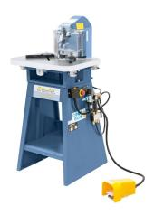
Die Bernardo AK 150 P Pneumatische Ausklinkmaschinen ist ein leistungsstarkes Werkzeug für die Metallverarbeitung. Die Maschine verfügt über eine maximale Blechstärke von 2,0 mm bei 400 N/mm² und 1,0 mm bei 600 N/mm². Der maximale Schnittdruck beträgt 2,2 Tonnen und die Maschine kann bis zu 40 Hübe pro Minute ausführen.
