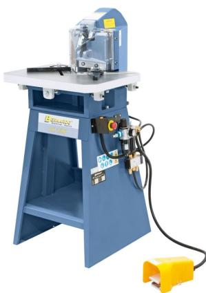
Die Bernardo AK 150 P Pneumatische Ausklinkmaschinen ermöglichen kraftschonendes Arbeiten durch pneumatischen Antrieb. Die Bedienung mittels Fußpedal lässt beide Hände frei für das Werkstück. Der Maschinenkörper besteht aus hochwertigem Grauguss, das Untergestell aus Stahlblech.
