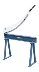
Der Bernardo GS 1000 ist ein Handschuh mit einer Schnittlänge von 1000 mm. Die Blechstärke beträgt 0,8 mm bei 400 N/mm². Das Produkt hat eine Länge von 1400 mm, eine Tiefe von 400 mm und eine Höhe von 1780 mm. Das Gewicht beträgt ca. 54 kg.
