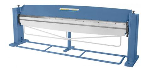
Die Bernardo BM 3020 Schwenkbiegemaschinen mit Scharfschiene ist eine leistungsstarke Maschine für die Metallverarbeitung. Die Maschine verfügt über eine Arbeitslänge von 3020 mm und kann Bleche mit einer Maximalstärke von 1,0 mm (bei 400 N/mm²) bearbeiten. Die maximale Öffnungsweite beträgt 40 mm und der Biegewinkel kann zwischen 0 und 135° eingestellt werden.
