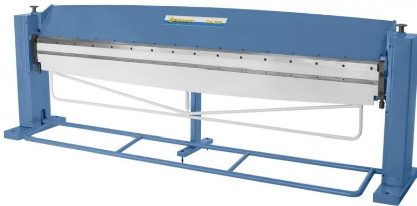
Die Bernardo BM 3020 Schwenkbiegemaschinen mit Scharfschiene ist eine universell einsetzbare Biegemaschine für Spenglereien und Handwerksbetriebe. Sie bietet eine lange Lebensdauer durch robuste Stahl-Schweißkonstruktion und ermöglicht einen schnellen und einfachen Biegevorgang mittels Bügelgriff.
