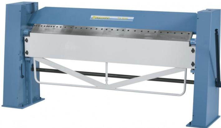
Die Bernardo TB 2020 Schwenkbiegemaschinen mit segmentierter Oberwange sind universell einsetzbare Biegemaschinen für Spenglereien und Reparaturbetriebe. Sie bieten eine hohe Oberwange zum Herstellen von hoch aufgekanteten Profilen und eine schnelle und einfache Verstellung der Oberwange für rationelles Arbeiten.
