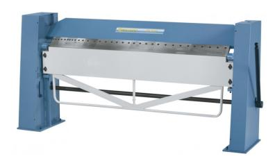
Die Bernardo TB 2020 Schwenkbiegemaschinen mit segmentierter Oberwange ist eine leistungsstarke Maschine für die Metallverarbeitung. Die Maschine bietet eine Arbeitslänge von 2020 mm und kann Bleche mit einer maximalen Stärke von 2,0 mm bearbeiten. Die maximale Öffnungsweite mit Segmente beträgt 122 mm und ohne Segmente 144 mm. Die Maschine hat eine Arbeitshöhe von 920 mm und eine Breite von 2750 mm. Die Tiefe beträgt 560 mm und die Höhe 1260 mm. Das Gewicht der Maschine beträgt ca. 1025 kg.
