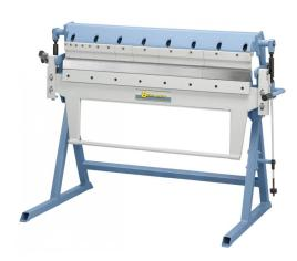
Die Bernardo B 1050 BOX Schwenkbiegemaschinen mit segm, Ober-, Unter- und Biegewange sind universell einsetzbare Biegemaschinen für Spenglereien und Reparaturbetriebe. Sie bieten eine einfache Schwenkbewegung der Biegewange mittels Bügelgriff und eine leichte Verstellung der Oberwange für rationelles Arbeiten.
