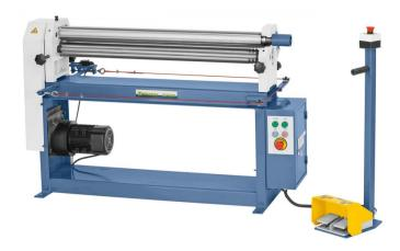
Die Bernardo ESR 1020 x 2,0 Motorische Rundbiegemaschinen ist eine leistungsstarke Maschine für die Bearbeitung von Blechen. Die Maschine verfügt über eine Walzenlänge von 1070 mm und kann Bleche mit einer Maximalstärke von 2,0 mm bearbeiten. Der Walzendurchmesser beträgt 75 mm und die Walzengeschwindigkeit kann bis zu 6 m/min betragen. Die Motorleistung beträgt 0,75 kW.
