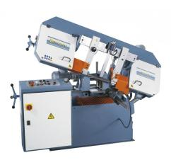
Professionelle Metallbandsägen zum Schneiden von Rohren, Profilen und Vollmaterialien aus Stahl oder Buntmetallen. Durch die umfangreiche Grundausstattung wie z.B.: der Manometer für die Bandspannung, die automatische Bandbruchkontrolle und die Bündelspanneinrichtung haben diese Maschinen ein optimales Preis-Leistungsverhältnis.
