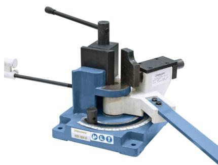
Der Bernardo WB 200 S Winkelbieger ist ein vielseitiges Werkzeug zum exakten Kalt- und Warmbiegen von Flach-, Rund- und Vierkantstählen. Die stabile Bauart ermöglicht das Festschrauben auf der Werkbank, während der stufenlos einstellbare Biegeanschlag und die Exzenter-Schnellspannung für rationelles Arbeiten sorgen. Der ablesbare Biegewinkel bis 120° und die hohe Wiederholgenauigkeit durch den Biegewinkelanschlag machen dieses Gerät ideal für Reparaturwerkstätten und Schlossereien.
