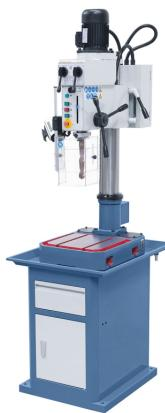
Für Handwerksbetriebe und Schlossereien ist diese robuste Getriebe-Tischbohrmaschine, mit einer Bohrleistung von max. 30 mm, eine preiswerte und leistungsstarke Maschine.
