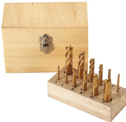
Die Bernardo TITAN-Schaftfräserkassette 12-tlg. umfasst Fräswerkzeuge in verschiedenen Größen. Die Kassette enthält 12 Teile, jeweils 6 Stück mit 2- bzw. 4-Schneiden, in den Größen 3 mm, 4 mm, 6 mm, 8 mm, 10 mm und 12 mm.
