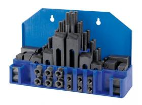
Das Bernardo Spannwerkzeugsortiment 58-tlg. ist ein 52-teiliges Basissortiment mit den am meisten benötigten Spannelementen zum schnellen Aufspannen von Werkstücken oder Vorrichtungen auf T-Nutentischen. Lieferung kompl. mit Plastikkassette, als Wandhalter verwendbar
