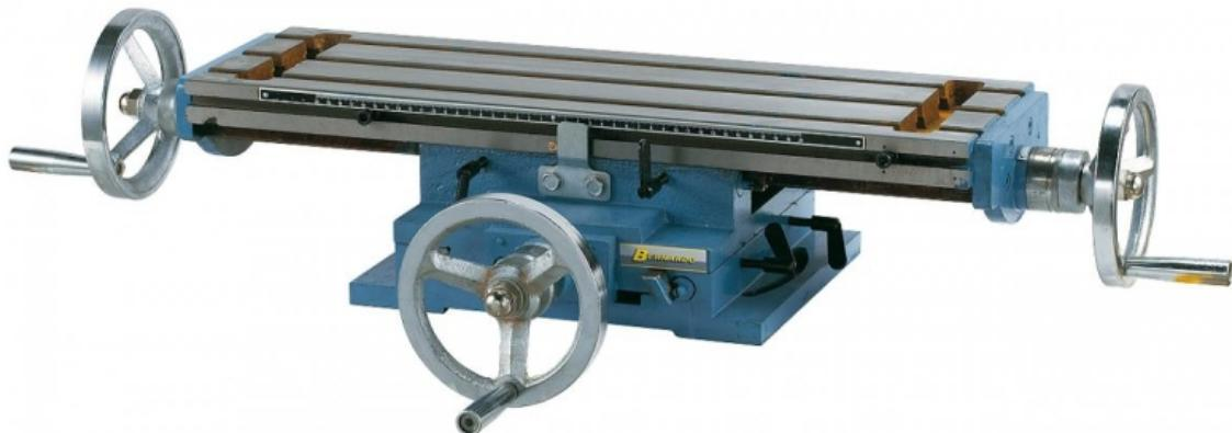
Der Bernardo Kreuztisch KT 205 ist ein vielseitiges Werkzeug für leichte Fräsanbeiten auf Tisch- oder Säulenbohrmaschinen. Die Aufspannfläche ist geschliffen und die Schwalbenschwanzführung wird durch Keilleisten nachgestellt.
