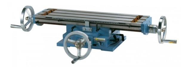
Der Bernardo Kreuztisch KT 205 ist ein vielseitiges Werkzeug für leichte Fräsarbeiten auf Tisch- oder Säulenbohrmaschinen. Die Aufspannfläche ist geschliffen und die Schwalbenschwanzführung wird durch Keilleisten nachgestellt.
