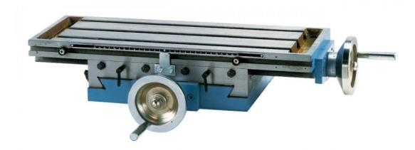
Der Bernardo Kreuztisch KT 195 ist ein Kreuztisch für leichte Fräsarbeiten auf Tisch- oder Säulenbohrmaschinen. Die Aufspannfläche ist geschliffen und die Schwalbenschwanzführung erfolgt durch Keilleisten, die nachstellbar sind.
