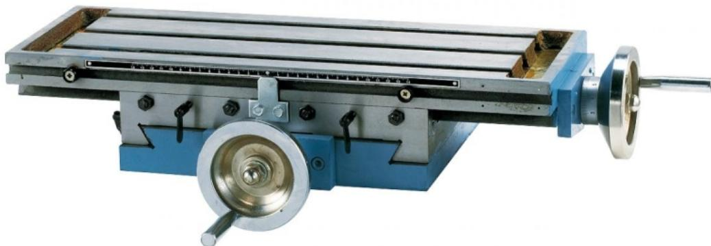
Der Bernardo Kreuztisch KT 195 ist ein Kreuztisch für leichte Fräsarbeiten auf Tisch- oder Säulenbohrmaschinen. Die Aufspannfläche ist geschliffen und die Schwalbenschwanzführung erfolgt durch Keilleisten, die nachstellbar sind.
