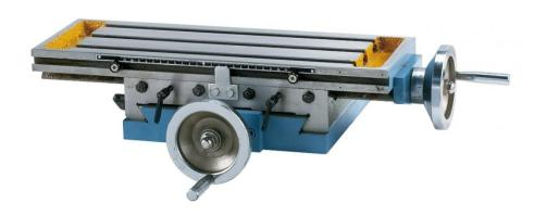
Der Bernardo Kreuztisch KT 165 ist ein Kreuztisch für leichte Fräsearbeiten auf Tisch- oder Säulenbohrmaschinen. Die Aufspannfläche ist geschliffen und die Schwalbenschwanzführung erfolgt durch Keilleisten, die nachstellbar sind.
