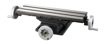
Der Bernardo Kreuztisch KT 150 ist ein Kreuztisch für leichte Fräsarbeiten auf Tisch- oder Säulenbohrmaschinen. Die Aufspannfläche ist geschliffen und die Schwalbenschwanzführung erfolgt durch Keilleisten, die nachstellbar sind.
