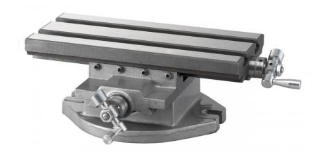
Der Bernardo Kreuztisch KT 140 ist ein Kreuztisch für leichte Fräsearbeiten auf Tisch- oder Säulenbohrmaschinen. Die Aufspannfläche ist geschliffen und die Schwalbenschwanzführung erfolgt durch Keilleisten, die nachstellbar sind.
