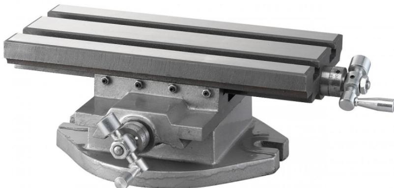
Der Bernardo Kreuztisch KT 140 ist ein Kreuztisch für leichte Fräsearbeiten auf Tisch- oder Säulenbohrmaschinen. Die Aufspannfläche ist geschliffen und die Schwalbenschwanzführung erfolgt durch Keilleisten, die nachstellbar sind.
