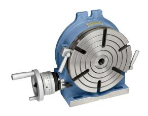
Der Bernardo Horizontal- und Vertikalrundtisch HV 10 Rundtische ist ein vielseitiges Werkzeug für Fräs- und Bohrarbeiten auf Horizontal- oder Vertikalfräsmaschinen, Bohrmaschinen usw. Die Tischplatte ist aus hochwertigem Meehaniteguß hergestellt. Schneckenwelle gehärtet und geschliffen, Schneckenrad aus Spezialguß.
