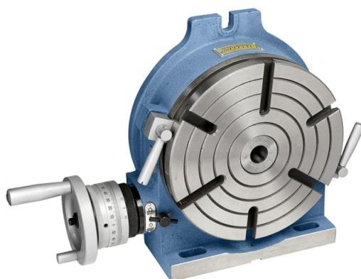
Der Bernardo Horizontal- und Vertikalrundtisch HV 10 Rundtische ist ein vielseitiges Werkzeug für Frä- und Bohrarbeiten auf Horizontal- oder Vertikalfräsmaschinen, Bohrmaschinen usw. Die Tischplatte ist aus hochwertigem Meehaniteguß hergestellt. Schneckenwelle gehärtet und geschliffen, Schneckenrad aus Spezialguß.
