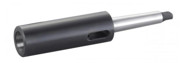
Die Bernardo Verlängerungshülse MK 2 / 2 Spannmittel für Werkzeuge ist eine präzise gefertigte Komponente. Die Verlängerungshülse ist für den Einsatz mit Morsekegel MK 2 konzipiert und weist eine Länge von 175 mm auf. Der Durchmesser beträgt 30 mm und der Innenkegel 17,780 mm.
