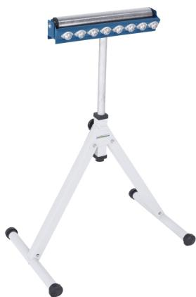
Optimale Hilfsmittel zur Auflage von langen und schweren Werkstücken. Große Auswahl an verschiedenen Modellen für unterschiedlichste Anwendung. Universell einsetzbar für z.B. Metallkreissägen, Bandsägen, Holzbearbeitungsmaschinen, ...
