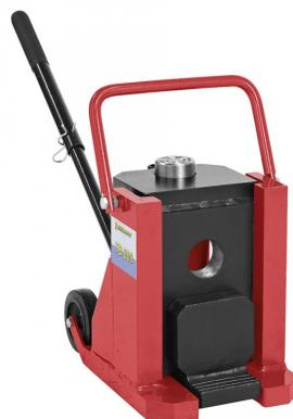
Der Bernardo TB 200 Maschinenheber ist ein vielseitiges Hebezeug für verschiedene Anwendungen. Die Traglasten variieren je nach Position und reichen von 12 to an der Hublasche bis hin zu 20 to am Kopf. Der Heber bietet einen Hubbereich von 35 - 195 mm mit Lasche Stufe 1, 165 - 325 mm mit Lasche Stufe 2 und 325 - 485 mm mit Kopf. Das Gewicht des Hebers beträgt etwa 68 kg.
