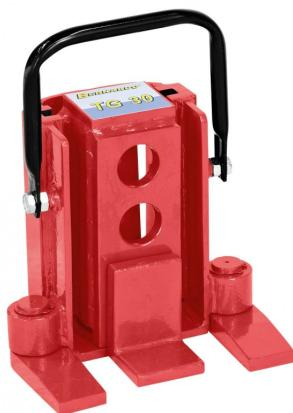
Der Bernardo TG 30 Maschinenheber ist ein vielseitiges Werkzeug für verschiedene Anwendungen. Die Traglast beträgt 3 to und der Hubbereich ist in drei Stufen unterteilt: 15 - 170 mm, 75 - 225 mm und 135 - 285 mm. Das Gewicht des Geräts beträgt ca. 21,5 kg.
