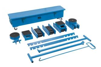
Das Bernardo SK 60 Schwerlast-Wälzwagenset ist ein robustes und vielseitiges Produkt für den Einsatz in verschiedenen Branchen. Es zeichnet sich durch eine Tragkraft von 60 to aus und ist somit für schwere Lasten geeignet. Der Ausgleichsaufsatz misst 130 x 130 mm und die Höhe beträgt 140 mm. Der Rollendurchmesser beträgt Ø 30 mm und der Drehscheibenaufsatz hat einen Durchmesser von Ø 150 mm. Das Gewicht des Wälzwagensets beträgt ca. 92 kg.
