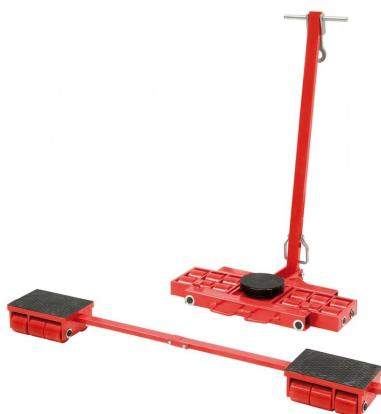
Das Bernardo STF 12 N + VTR 12 N Schwerlast-Transportfahrwerk Set ist ideal für den Transport von schweren Lasten. Die Traglast beträgt 24000 kg. Die Abmessungen der Drehplatten betragen Ø 180 mm für das STF und 220 x 180 mm für das VTR. Die Länge der Lenkdeichsel beträgt 1100 mm und der Verstellbereich des VTR liegt zwischen 400 und 1400 mm.
