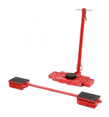
Das Bernardo STF 12 N + VTR 12 N Schwerlast-Transportfahrwerk Set ist ideal für den Transport von schweren Lasten. Die Traglast beträgt 24000 kg. Die Abmessungen der Drehplatten betragen  $\emptyset$  180 mm für das STF und 220 x 180 mm für das VTR. Die Länge der Lenkdeichsel beträgt 1100 mm und der Verstellbereich des VTR liegt zwischen 400 und 1400 mm.
