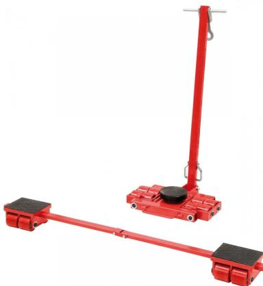
Das Bernardo STF 8 N + VTR 8 N Schwerlast-Transportfahrwerk Set ist ein hochwertiges Produkt für den Transport von schweren Lasten. Die Traglast beträgt 16000 kg. Die Abmessung der Drehplatte (STF) beträgt Ø 160 mm und die Abmessung der Drehplatte (VTR) beträgt 200 x 160 mm.
