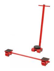
Das Bernardo STF 4 N + VTR 4 N Schwerlast-Transportfahrwerk Set ist ein vielseitiges Transportsystem. Es besteht aus zwei Teilen: dem STF 4 N und dem VTR 4 N. Der STF 4 N hat eine Drehplatte mit einem Durchmesser von  $\emptyset$  150 mm und eine Lenkdeichsel von 1000 mm Länge. Der VTR 4 N hat eine Drehplatte mit den Abmessungen 130 x 130 mm und einen Verstellbereich von 300 - 1000 mm.
