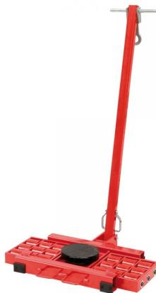
Das Bernardo STF 18 N Schwerlast-Transportfahrwerk ist ein robustes und zuverlässiges Transportmittel für schwere Lasten. Es verfügt über eine Traglast von 18000 kg und eine Drehplatte mit einem Durchmesser von Ø 200 mm. Die Lenkdeichsel ist 1500 mm lang und die Abmessungen des Fahrwerks betragen 780 x 55 x 110 mm. Das Fahrwerk ist mit 18 Rollen ausgestattet und wiegt etwa 138 kg.
