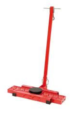
Das Bernardo STF 16 N Schwerlast-Transportfahrwerk ist ein robustes und zuverlässiges Transportmittel für schwere Lasten. Es bietet eine Traglast von 16000 kg und eine Abmessung der Drehplatte von  $\emptyset$  200 mm. Die Länge der Lenkdeichsel beträgt 1400 mm und die Abmessungen des Fahrwerks betragen 936 x 520 x 110 mm. Das Fahrwerk ist mit 16 Rollen ausgestattet und hat ein Gewicht von ca. 124 kg.
