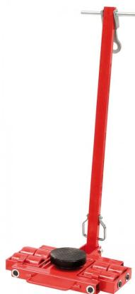
Das Bernardo STF 8 N Schwerlast-Transportfahrwerk ist ein robustes und zuverlässiges Transportmittel für schwere Lasten. Es verfügt über eine Traglast von 8000 kg und eine Drehplatte mit einem Durchmesser von Ø 160 mm. Die Lenkdeichsel ist 1100 mm lang und die Abmessungen des Fahrwerks betragen 560 x 470 x 110 mm. Es ist mit 8 Rollen ausgestattet und wiegt etwa 72 kg.
