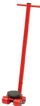
Das Bernardo STF 4 N Schwerlast-Transportfahrwerk ist ein robustes und zuverlässiges Transportmittel für schwere Lasten. Es verfügt über eine Traglast von 4000 kg und eine Drehplatte mit einem Durchmesser von Ø 150 mm. Die Lenkdeichsel ist 1000 mm lang und die Abmessungen des Fahrwerks betragen 230 x 230 x 110 mm. Das Fahrwerk ist mit 4 Rollen ausgestattet und wiegt ca. 28 kg.
