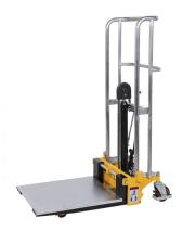
Der Bernardo GH 1200 Gabel-Hublift ist ein manuell angetriebenes Hebehilfsgerät. Es verfügt über eine Feststellbremse, die manuell bedient wird. Die Tragkraft des Geräts beträgt 400 kg.
