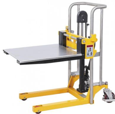
Der Bernardo GH 850 Gabel-Hublift ist ein manuell angetriebenes Gerät mit einer Tragkraft von 400 kg. Die Lenkkettenabmessung Ø 125 x 35 mm und die Gabelkettenabmessung Ø 75 x 30 mm. Die Gabellänge beträgt 650 mm, die Gabelbreite 100 mm und die Gabelhöhe 50 mm.
